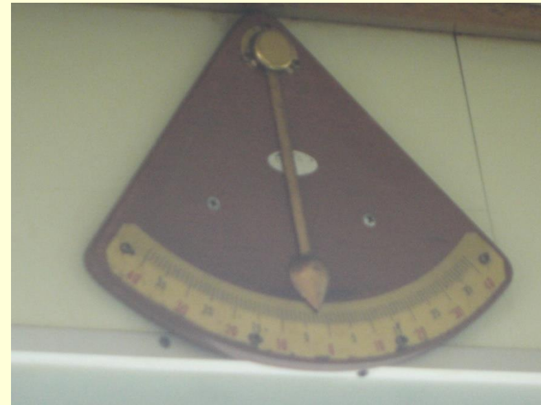
alat ukur sudut kemiringan kapal
