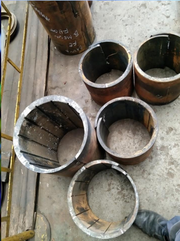
(Bantalan lama yang wear limit)
